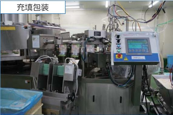
機械名称：ロータリー式真空包装机・自動充填機 1式
